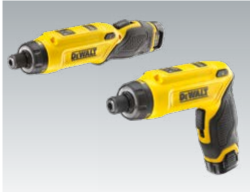
Gyroskopické ovládanie - otočením ruky doľava sa zapína ľavý chod a kontrolujú otáčky, pohybom ruky doprava sa zapína pravý chod a kontrolujú otáčky.
